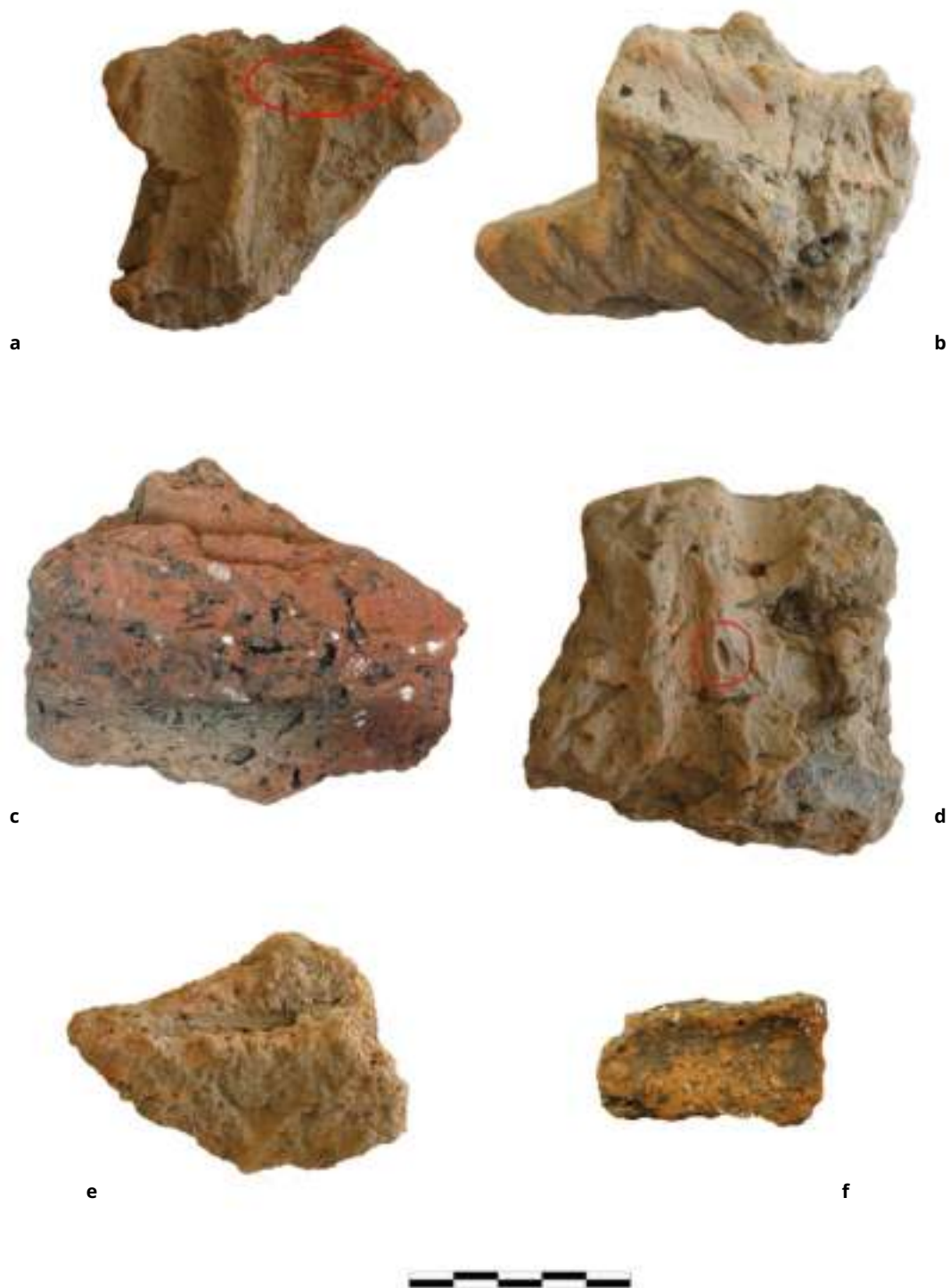
Figura 2. Huellas y restos de estabilizantes en los morteros: a. Tallo (28/3-M-027, La Peña del Castro); b. Hierbas (28/3-M-007, La Peña del Castro); c. Cal (06/1-M-129, Llagú); d. Semilla o gluma (28/3-M-025, La Peña del Castro); e. Ramita (28/3-M-028, La Peña del Castro); f. Piedras (06/1-M-047, Llagú). © Lucía Ruano
